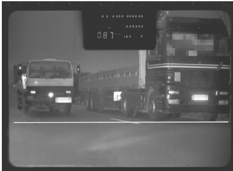
Abbildung 7 – Verkehr auf mehreren Fahrstreifen, Überholverkehr, mit Messlinie
